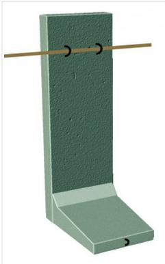
Bei Elementen mit einer Höhe von bis zu 130 cm dienen die auf der Rückseite angebrachten Ösen zum Transport
